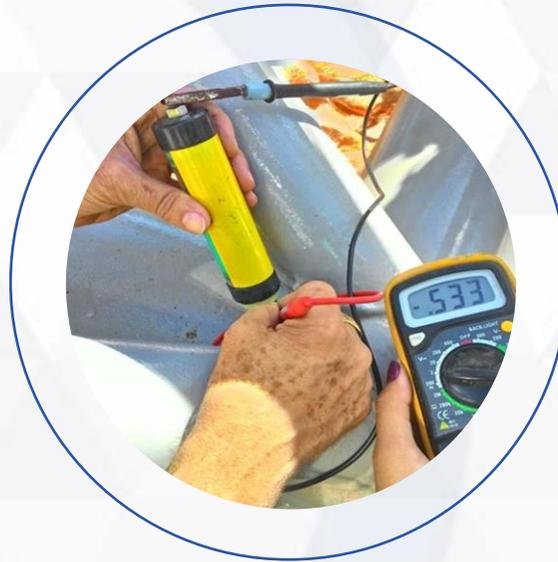
A estrutura tratada com FP tem sido monitorada por potenciais eletroquímicos e permanece em perfeitas condições;
